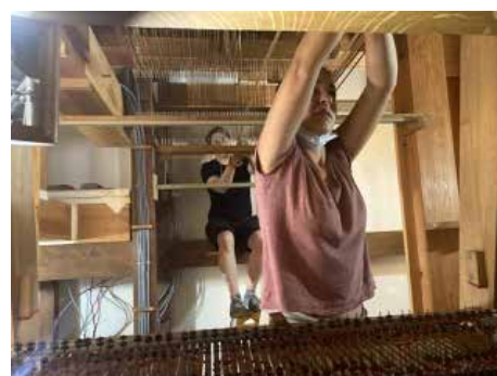
Remontage de la mécanique de l'orgue D.Kern dans la nouvelle salle
